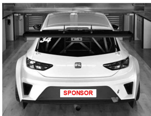
Disegno n° 3: Targa posteriore: modalità di applicazione
