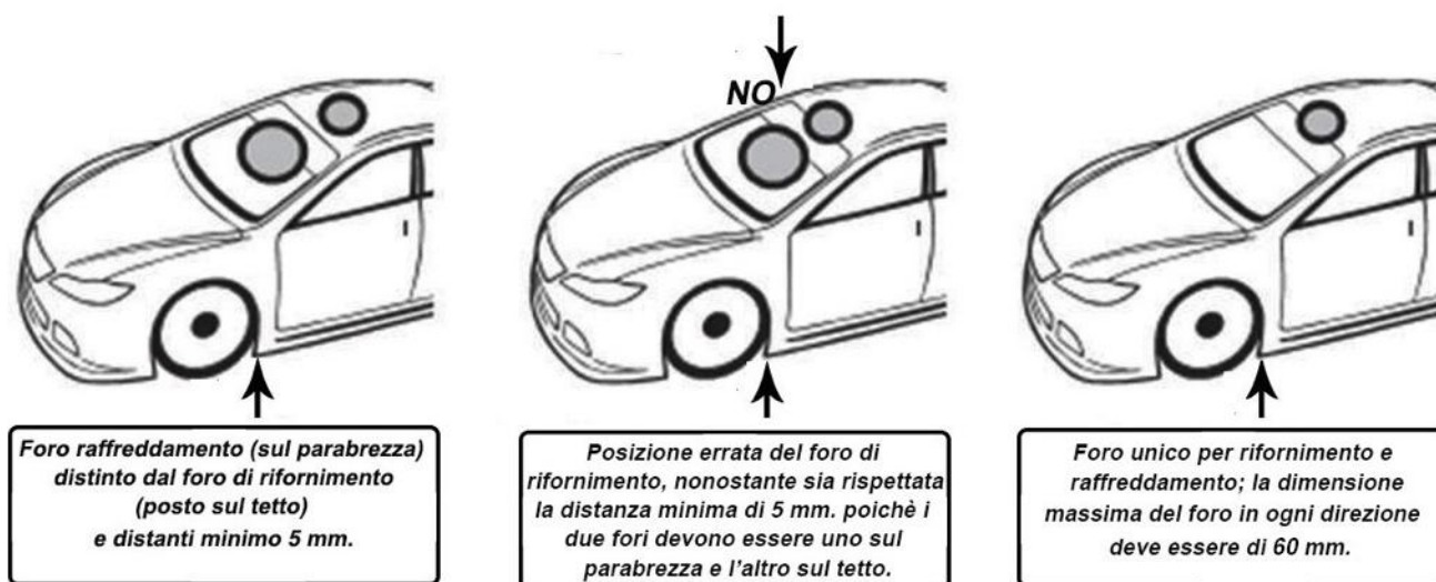
Figura 32 : Posizione fori per raffreddamento e rifornimento.
