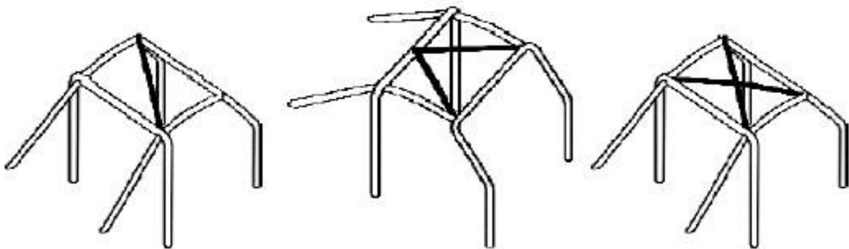
Il tubo di rinforzo che congiunge longitudinalmente il punto più alto della B-bar all'altro lato della A-bar, deve essere rinforzato in ogni angolo secondo il disegno sottostante.
