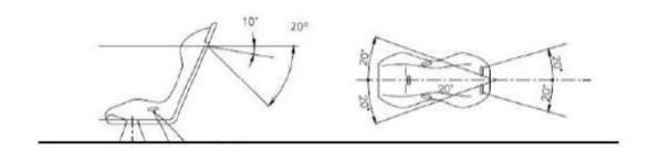
Per agganciare le due cinghie delle spalle (nel rispetto delle angolazioni sopra descritte), é ammesso aggiungere un tubo trasversale che deve essere saldato all'interno dell'arco principale gusto dietro al sedile del pilota.
