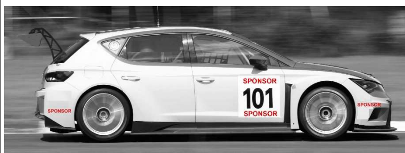
Disegno n° 1: Placca Portanumero e adesivi su paraurti: modalità di applicazione
