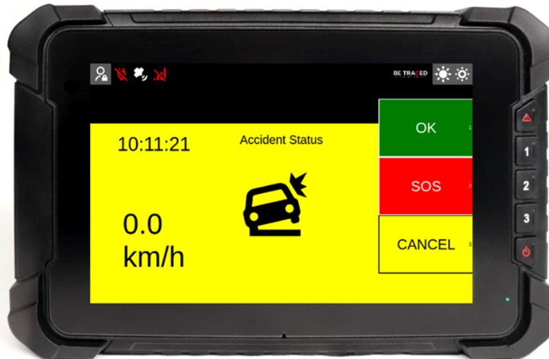
Figura 5: Schermata di probabile incidente (appare dopo uno stop di almeno 15 secondi in Prova Speciale)
